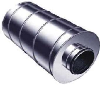
Трубчатый шумоглушитель TRSE выполняется в виде 2-х круглых воздуховодов, вставленных один в другой. пространство между наружным и внутренним воздуховодами заполнено звукопоглощающим материалом.
