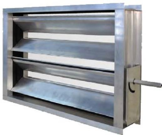
Заслонка DE состоит из прямоугольного корпуса и установленных в него жалюзи, которые через систему зубчатых колес (закрытого типа) поворачиваются на требуемый угол при помощи ручного либо электрического привода. Корпус и жалюзи выполнены из алюминиевого профиля системы Arosio.
